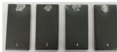
防腐耐磨耐热熔结环氧复合涂层盐雾腐蚀后形貌无变化
